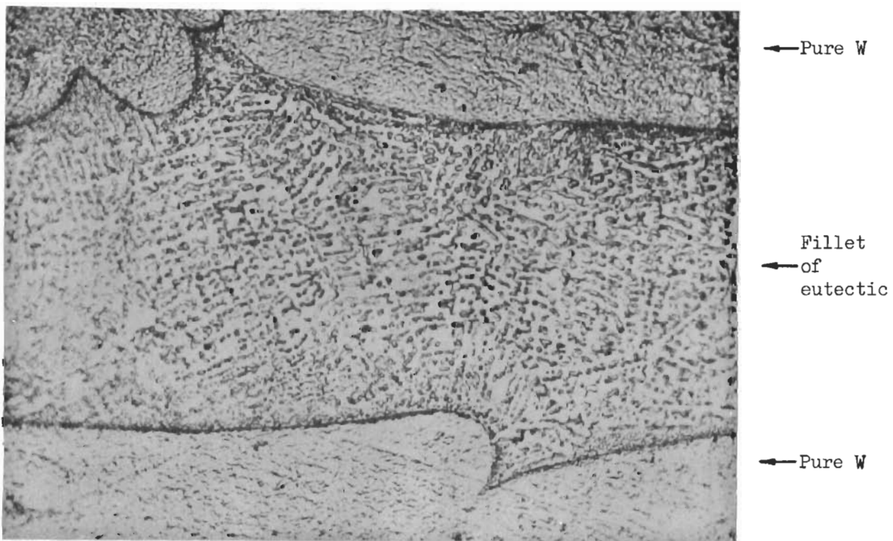
Fig. 2 (II) W-WBe 2 eutectic. (x 1200)
