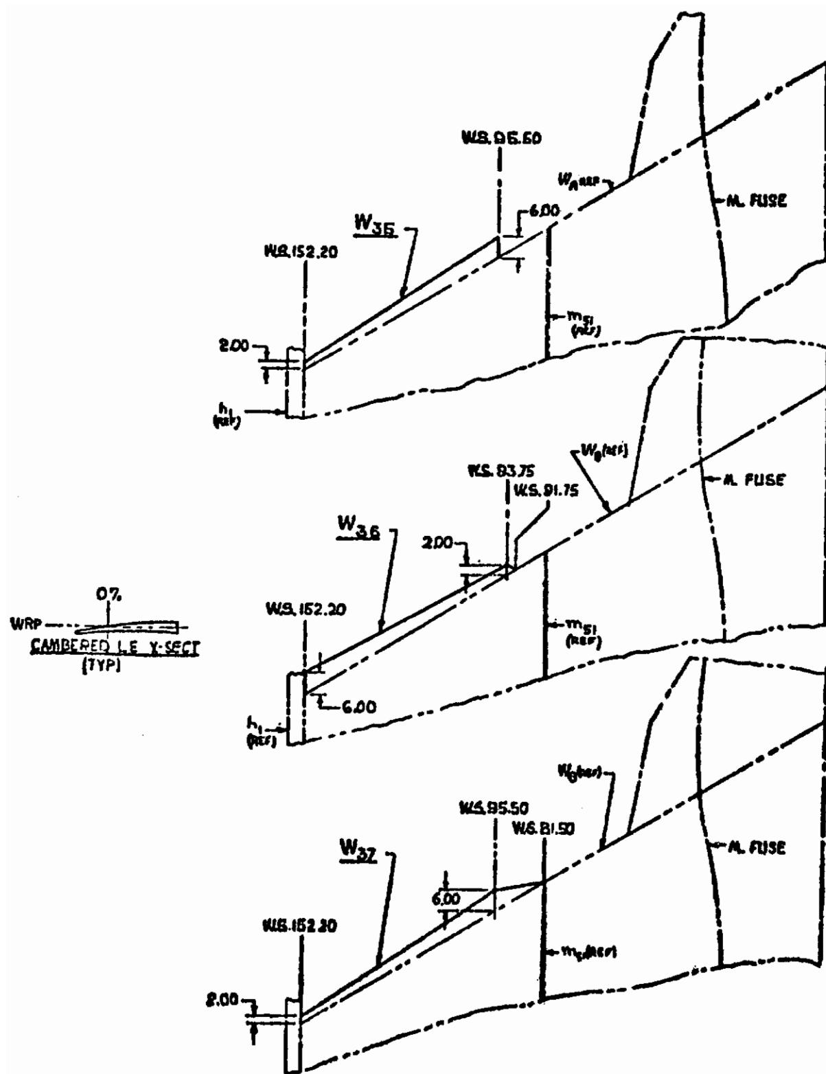
Figure 283. Leading Edge Sawtooth
