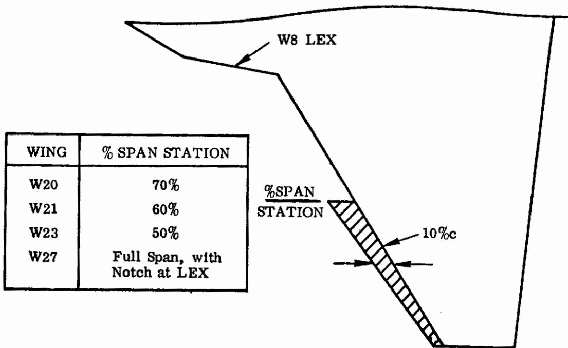
Figure 247. Leading Edge Sawtooth
