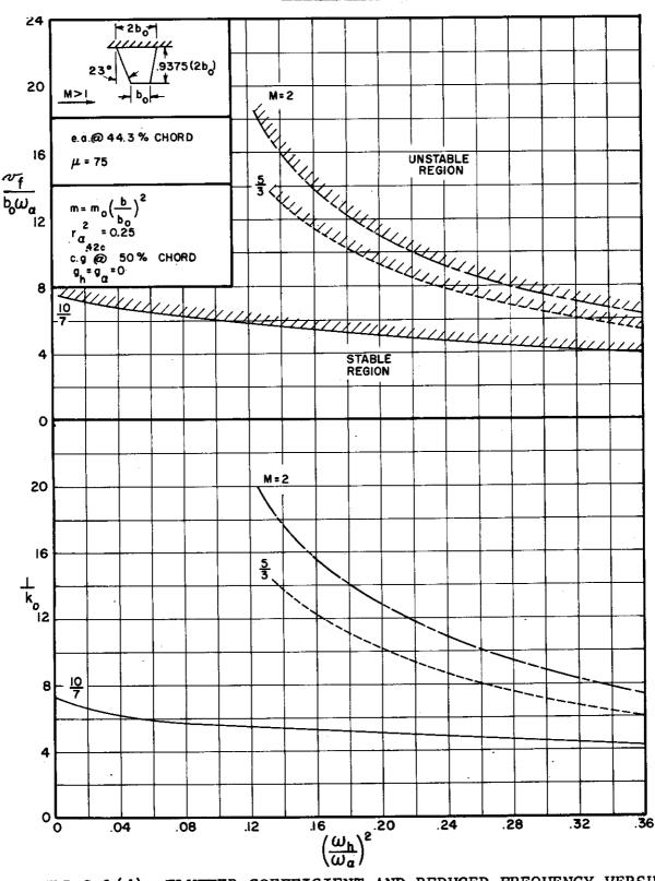
FIGURE C.1(d) FLUTTER COEFFICIENT AND REDUCED FREQUENCY VERSUS FREQUENCY RATIO FOR BARE STRAIGHT-WING PLANFORM,
