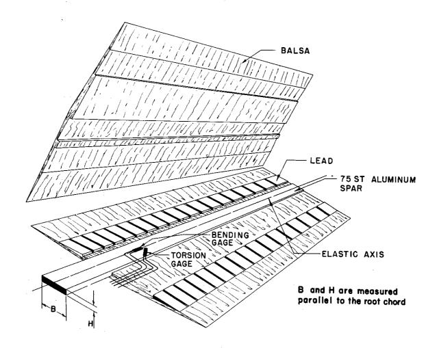
FIGURE D.1 A TYPICAL SUPERSONIC FLUTTER MODEL
