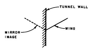
FIGURE 3.16 SEMI-SPAN MODEL WITH FREEDOM TO ROLL IN WIND TUNNEL
