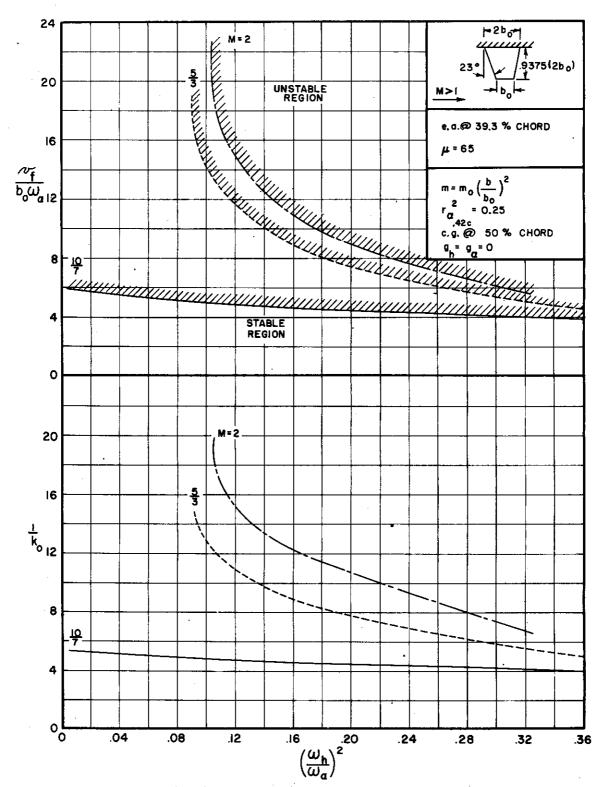
FIGURE C.1(c) FLUTTER COEFFICIENT AND REDUCED FREQUENCY VERSUS FREQUENCY RATIO FOR BARE STRAIGHT-WING PLANFORM,
