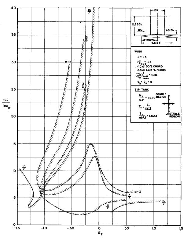
FIGURE C.7(a) FLUTTER COEFFICIENT VERSUS TIP-TANK STATIC-UNBALANCE PARAMETER FOR STRAIGHT-WING PLANFORM, FREE-TO-ROLL
