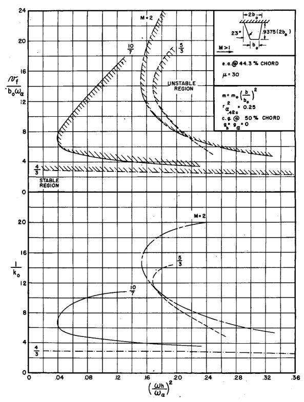
FIGURE C.1(e) FLUTTER COEFFICIENT AND REDUCED FREQUENCY VERSUS FREQUENCY RATIO FOR BARE STRAIGHT-WING PLANFORM,
