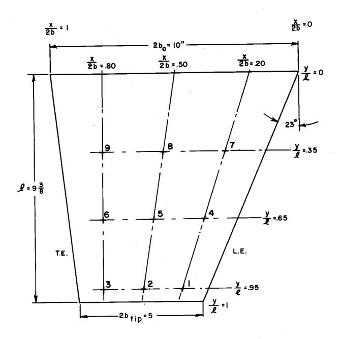
FIGURE D.7 LOCATION OF INFLUENCE-COEFFICIENT POINTS FOR STRAIGHT-WING MODELS
