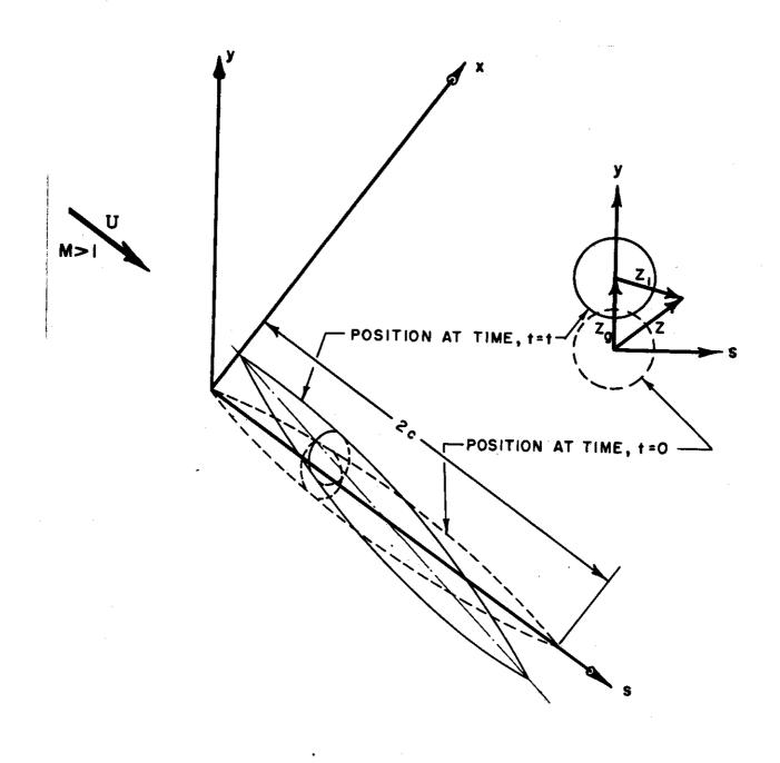
FIGURE B.1 AXIS SYSTEM FOR TIP-TANK AERODYNAMIC THEORY
