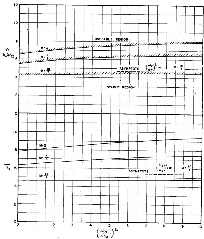
FIGURE C.2 FLUTTER COEFFICIENT AND REDUCED FREQUENCY VERSUS FREQUENCY RATIO FOR STRAIGHT WING WITH AILERON
