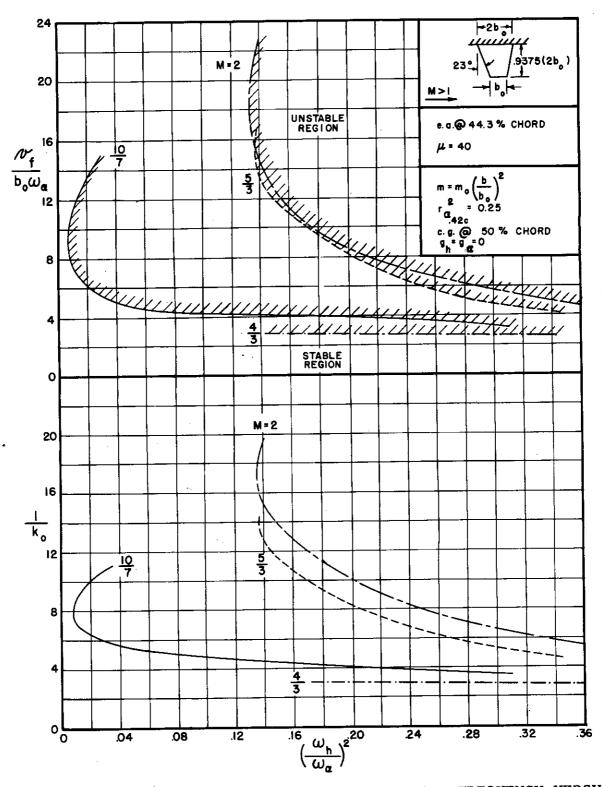
FIGURE C.1(f) FLUTTER COEFFICIENT AND REDUCED FREQUENCY VERSUS FREQUENCY RATIO FOR BARE STRAIGHT-WING PLANFORM,
