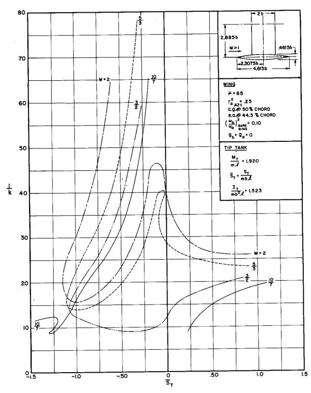
FIGURE C.7(b) REDUCED FREQUENCY VERSUS TIP-TANK STATIC-UNBALANCE PARAMETER FOR STRAIGHT-WING PLANFORM, FREE-TO-ROLL
