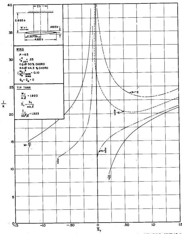
FIGURE C.4(b) REDUCED FREQUENCY VERSUS TIP-TANK STATIC-UNBALANCE
