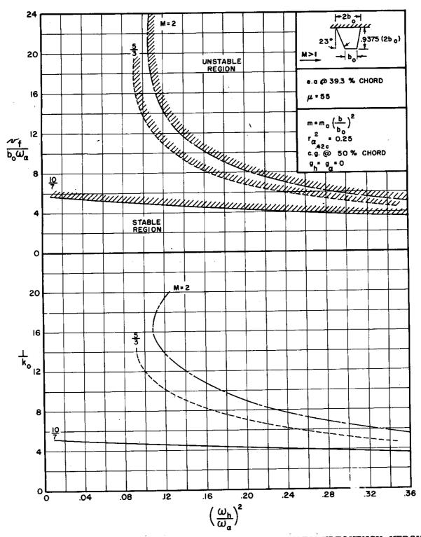
FIGURE C.1(b) FLUTTER COEFFICIENT AND REDUCED FREQUENCY VERSUS FREQUENCY RATIO FOR BARE STRAIGHT-WING PLANFORM,
