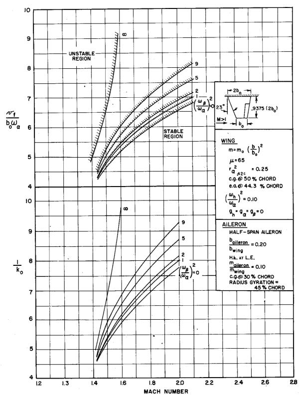
FIGURE 3.12 THEORETICAL RESULTS FOR STRAIGHT WING WITH ATLERON
