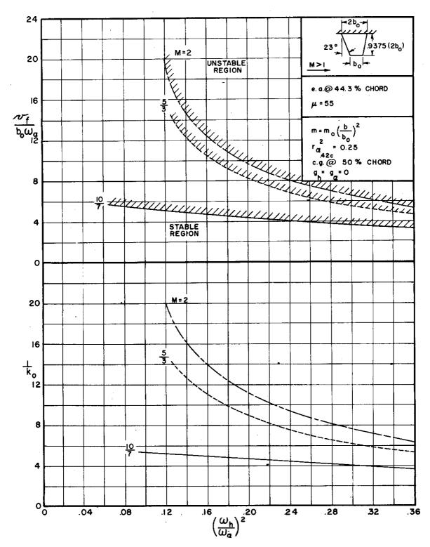
FIGURE C.1(g) FLUTTER COEFFICIENT AND REDUCED FREQUENCY VERSUS FREQUENCY RATIO FOR BARE STRAIGHT-WING PLANFORM,
