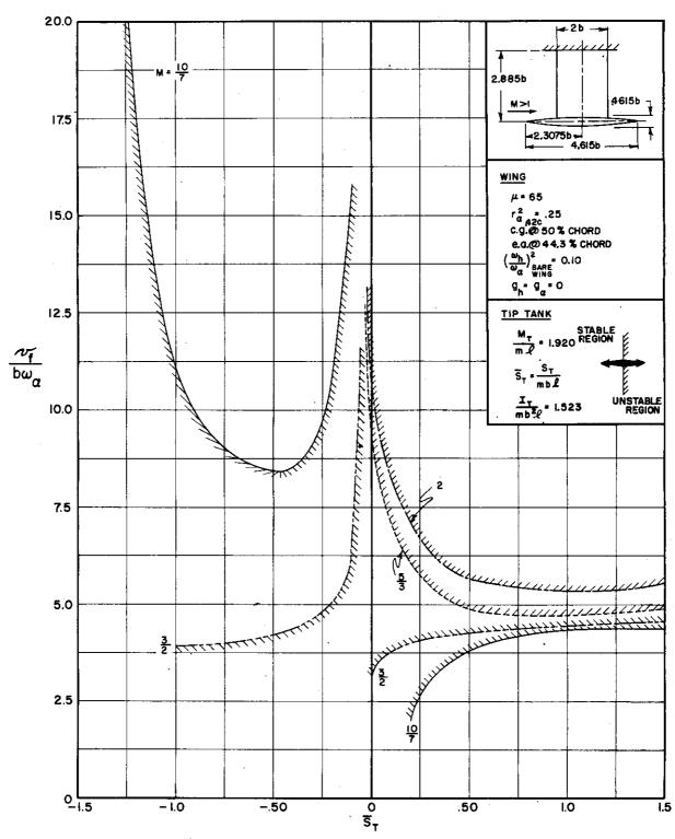
FIGURE C.4(a) FLUTTER COEFFICIENT VERSUS TIP-TANK STATIC-UNBALANCE
