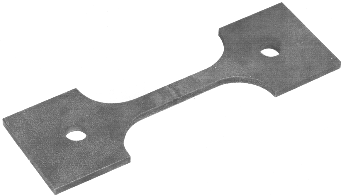
Fig. 4 Tungsten Tensile Specimen
