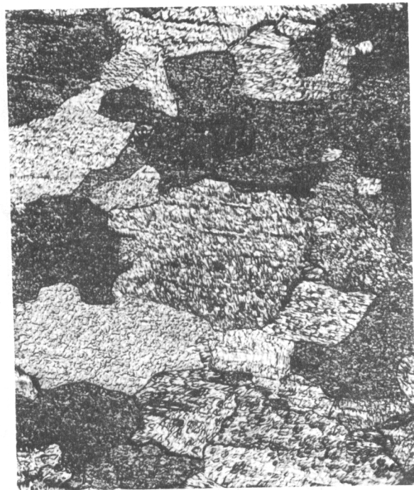
Fig. 34 Recrystallized 0.100-in. Tungsten; X200
