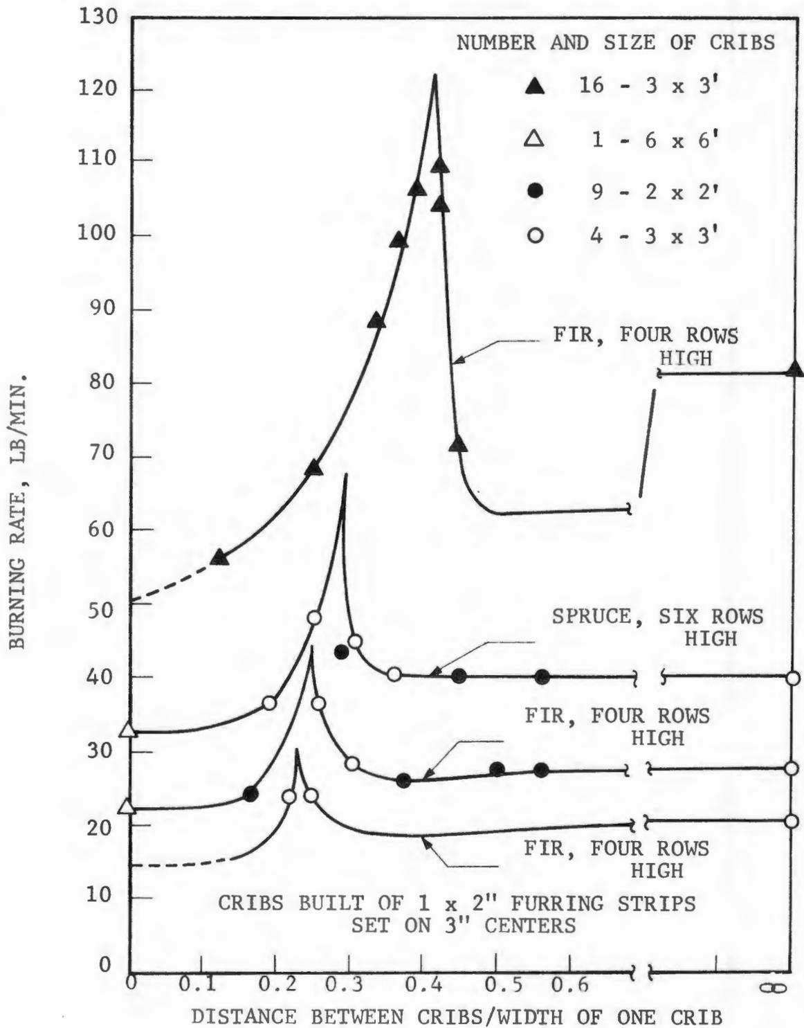
Fig. 7 BURNING RATE AS A FUNCTION OF THE DISTANCE BETWEEN CRIBS
