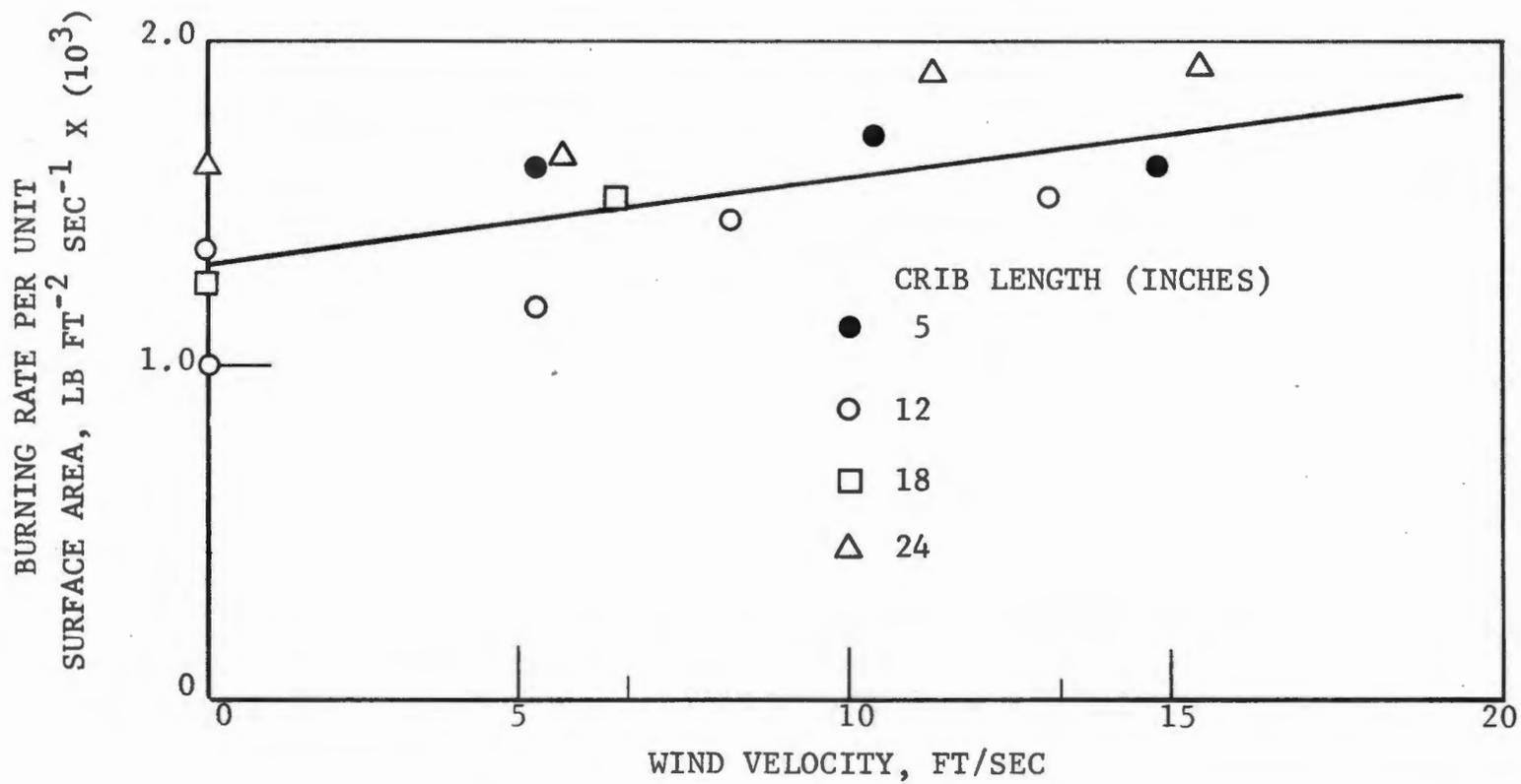
Fig. 4 EFFECT OF WIND ON BURNING RATES
