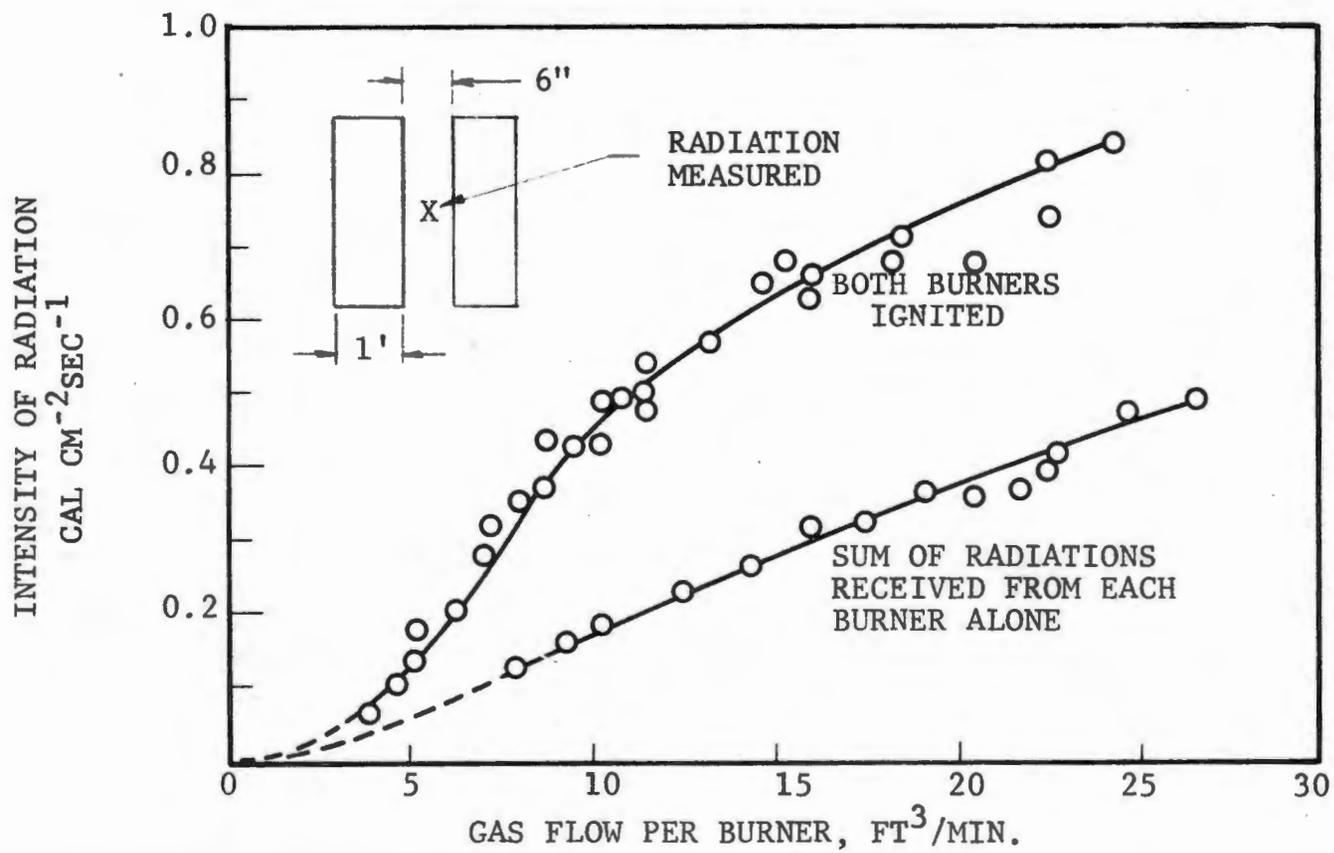
Fig. 6 RADIATION FROM TWO GAS BURNERS
