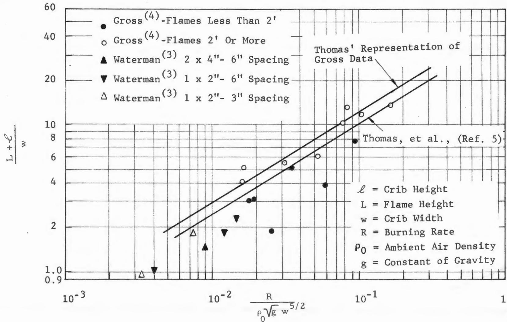
Fig. 1 EFFECT OF BURNING RATES ON FLAME HEIGHT FROM FREE BURNING FIRES
